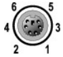
Figura B-3. Números de patilla de los conectores para ratón y teclado compatibles con PS/2
